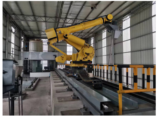
广西金川集团汽车车厢矿粉机器人采制样系统
